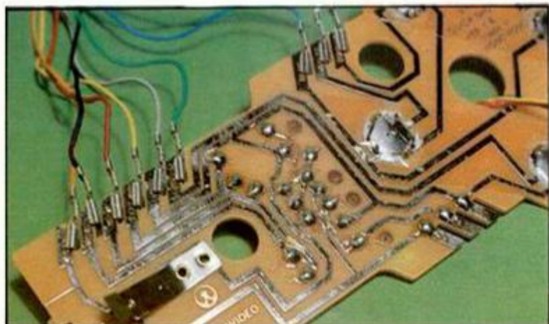
Internamente contiene bastante más circuitería de la necesaria ya que está previsto también para otros ordenadores.
